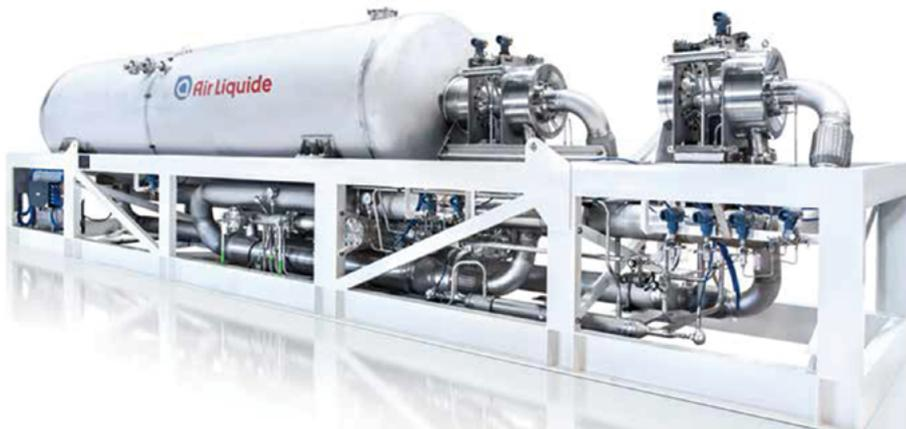
■ 그림 4. Turbo-Brayton(TBF-350, Air Liquide)
